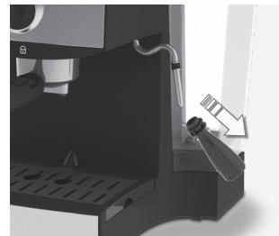
3. **Uvoľnite dýzu na paru** a umyte ju pod tečúcou vodou. Malú trubičku vycistite pomocou utierky. Vytiahnite nádobu na vodu a opláchnite ju pod tečúcou vodou.
