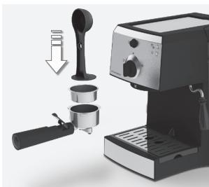
**5. Parmak koruyucusunu arkaya doğru katlayın ve filtre tutucusunu filtreye yerleştirin.** Filtreyi öğütülmüş kahve ile doldurun. Öğütülmüş kahveyi hafifçe sıkıştırmak için kaşının diğer tarafındaki sıkıştırıcıyu kullanın.
